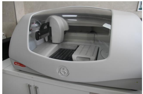
Centro: CIMFA Quillacollo Analizador automático de química sanguínea - Laboratorio
